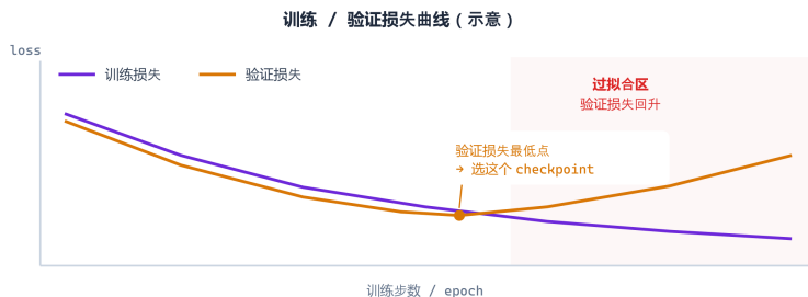
图 4-4 训练/验证损失曲线：验证损失先降后升，就是过拟合信号，取最低点对应的 checkpoint
