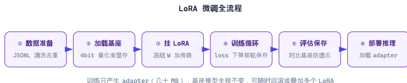
图 4-3 LoRA 微调全流程：数据 → 加载 → 挂 LoRA → 训练 → 评估 → 部署
