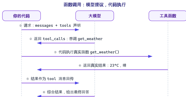
图 2-3 函数调用交互序列图：模型 ↔ 代码 ↔ 工具，六步完成一次“带工具的问答”
